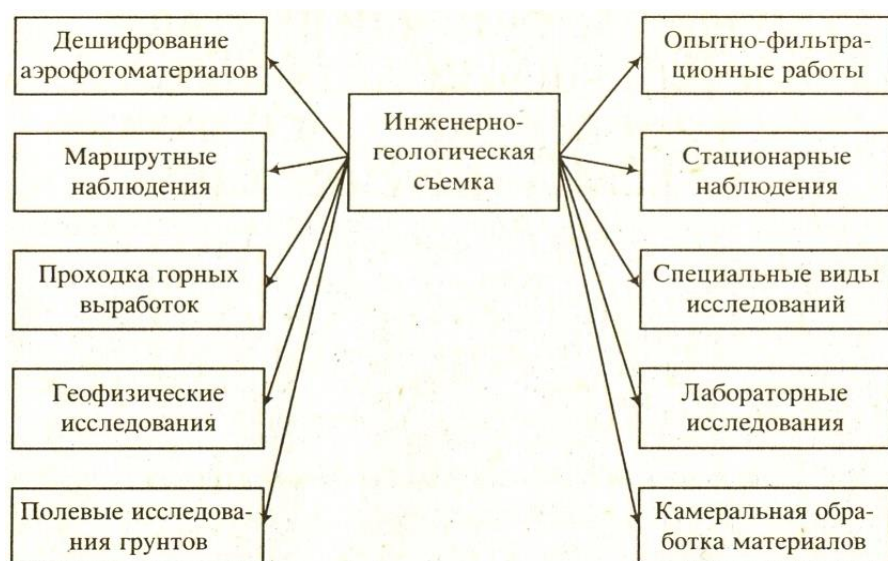
Рисунок 1. Схема ведения инженерно геологической съемки
