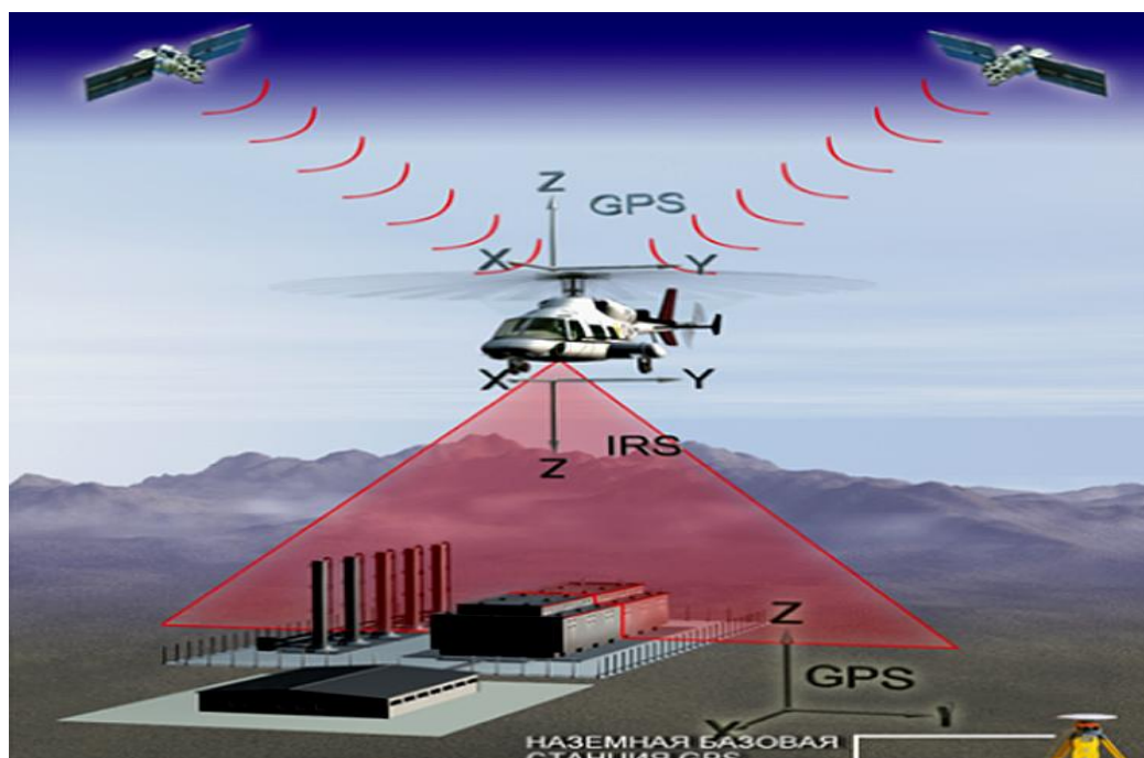
Рис. 2. Пример работы наземного сканера
